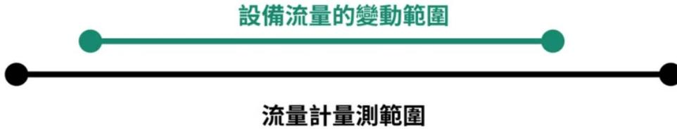
我們可以參考量程選擇符合需求的流量計，如果設備量測的範圍在20-100lpm之間，100除以20為5，建議選擇量程大於1:5的流量計，另外，建議流量計所能量測的最低流量要小於20 lpm，最大流量要大於100 lpm，譬如說可以選擇量測範圍15~150 lpm的流量計，或是10~200 lpm的流量計。
