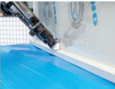
标准设备: 用于监测泄露的凹槽
